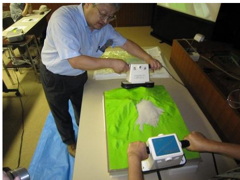
岩屑なだれを再現する実験の様子
